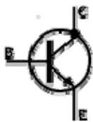
Transistor NPN con colector unido a la cubierta
